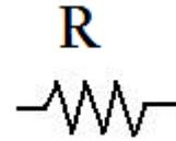
➤ Le conducteur ohmique dite aussi « résistor » installé dans un circuit a pour effet la diminution de l'intensité notée «  $I$  » du courant électrique dans le circuit.
